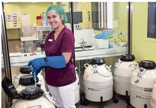
Bei minus 196 Grad Celsius werden Eizellen und Samenproben in flüssigem Stickstoff konserviert.
